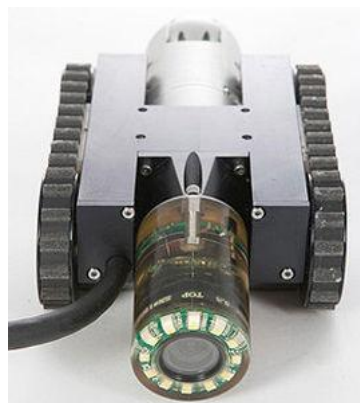
Рис. 2. Гусеничный робот-контроллер NanoMag [2].
